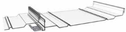
Das einschalige PC Panel 2250-C ist mit einer Breite von 250 mm und einem Gewicht von nur ca. 1,9 kg/m<sup>2</sup> das ideale Produkt für eine funktionale und optisch ansprechende transluzente Dachverglasung. Das Multifunktions-Panel besteht aus hochschlagfestem, UV-stabilisiertem Polycarbonat und kann in zahlreichen Farben produziert werden. Der Anwendungsbereich erstreckt sich von Überdachungen für Terrassen, Carports, Gewächshäuser bis hin zu Vordächern und vielem mehr.
